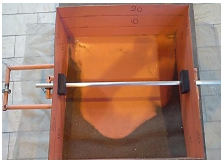
شکل ۱- پلاستیک قرار گرفته در جلوی حفره‌ها (به منظور ممانعت از بیرون ریختن ماسه)
