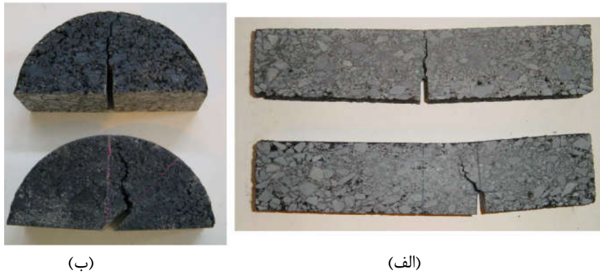
شکل ۱-۷: الف) نمونه SENB بعد از شکست مود I و مود ترکیبی (ب) نمونه SCB بعد از شکست مود I و مود ترکیبی
