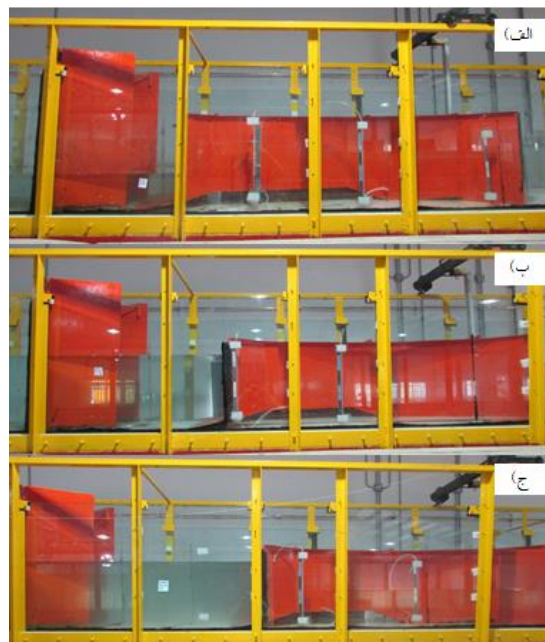
شکل ۳- تصاویری از فلوم آزمایشگاهی، دریچه سالونی و پارشال فلوم، الف) d=0 ، ب) d=B/2 و ج) d=B
