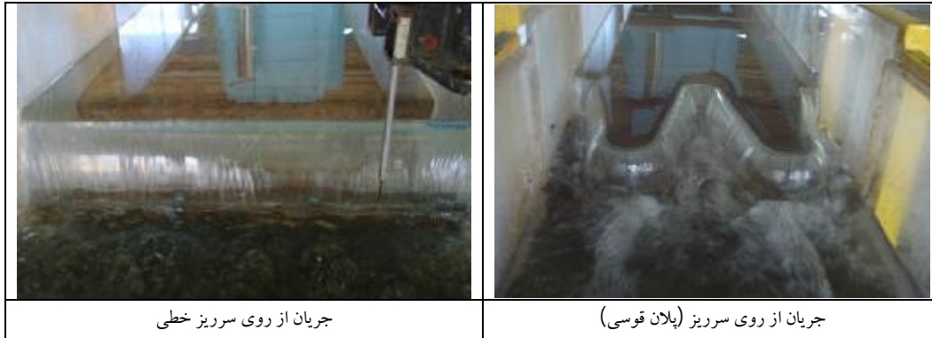
شکل 3- مقایسه جریان بر روی سرریزهای خطی و زیگزاگی (با پلان قوسی)
