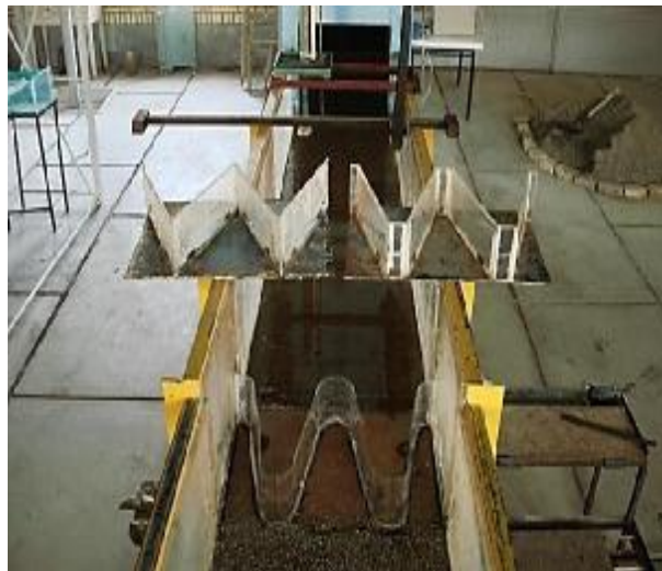
شکل 1- نمایی از سرریزهای زیگزاگی با پلان مثلثی، دوزنقه‌ای و قوسی مورد استفاده در این تحقیق
