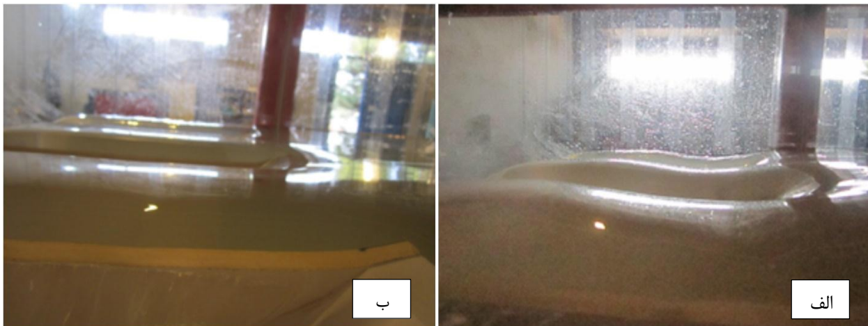
شکل ۵- الف) پروفیل سطح آب سرریز نوع D ب) پروفیل سطح آب سرریز نوع A
